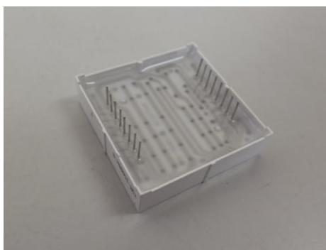
図2 8×8マトリクスLEDのピン配置
